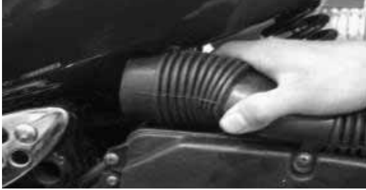
Steg 1 : Ta försiktigt loss ena änden av slangen till luftfiltret.
